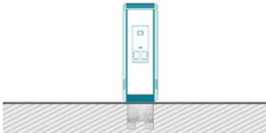
Le socle en béton n'est monté que dans un sol présentant une capacité de charge et une nature du terrain suffisantes.
